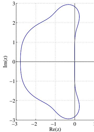
Figure 1: La regione di assoluta stabilità del metodo RK4 è la parte di piano interna alla curva chiusa
