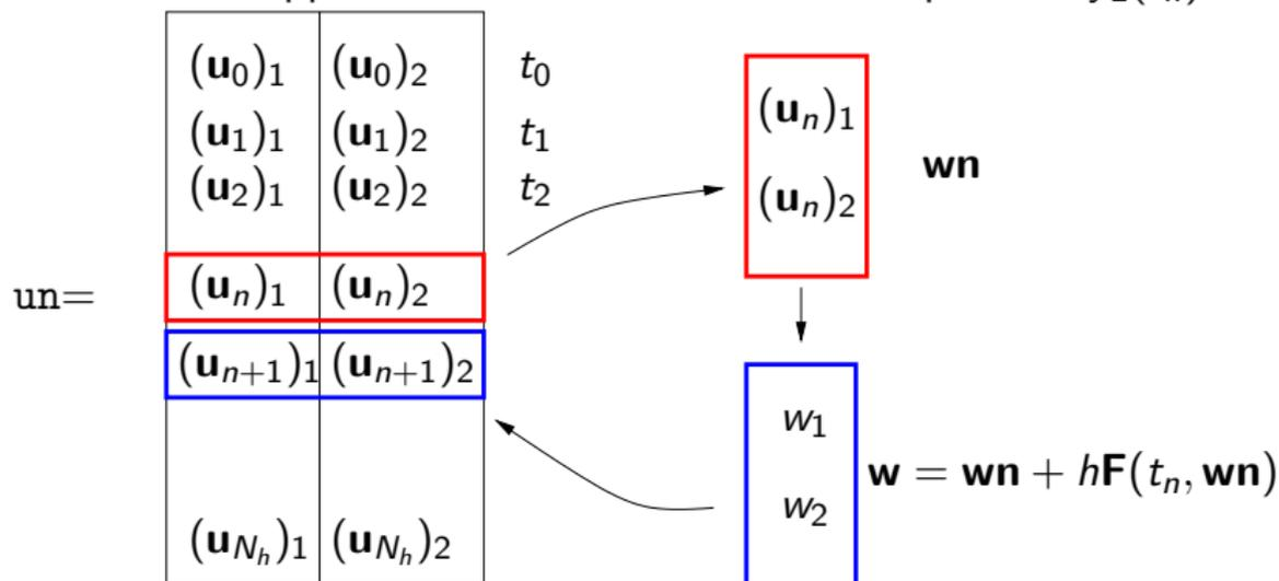
La funzione  $f = \text{odefun}(t, y)$  prende in input  $t$  scalare e  $y$  vettore colonna e produce il vettore  $f$  della stessa dimensione di  $y$  (colonna)
